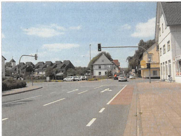
Abb. 5-18: Vorbeifahrstreifen in einer signalisierten Knotenpunktzufahrt (Bielefeld)
