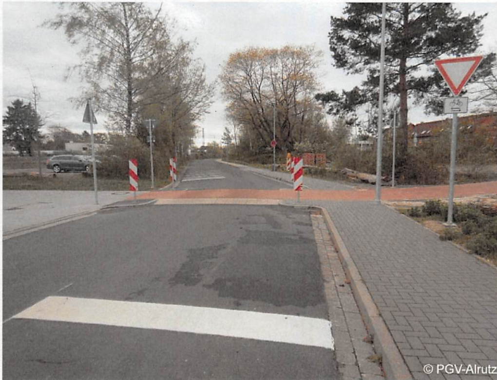
Abb. 5-30: Aufgepflasterte Querungsstelle – Neustadt am Rübenberge
