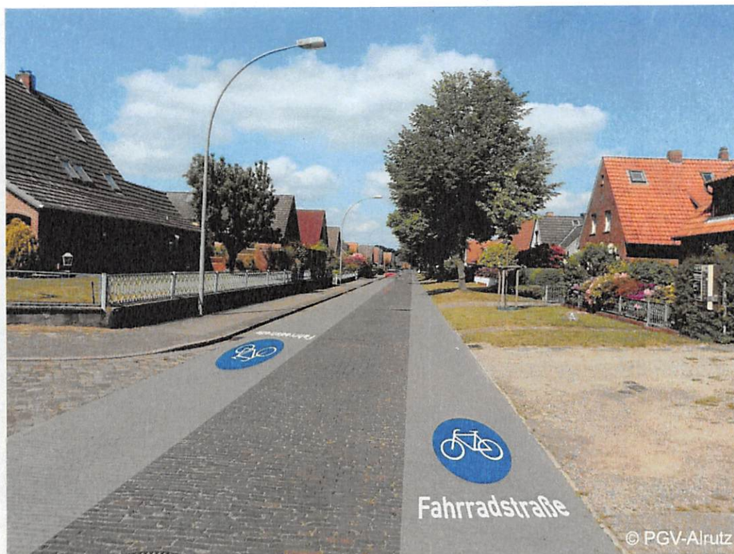
Abb. 5-24: Prinzipskizze für die Gestaltung einer Fahrradstraße mit asphaltierten Randstreifen „Auf den Rathen“ (Fotomontage)
